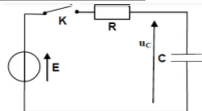
On ferme le circuit à l'instant  $t = 0$  et on visualise, en utilisant une interface informatique sur l'écran d'un ordinateur les variations de la tension  $u_c$  aux bornes du condensateur en fonction du temps.
