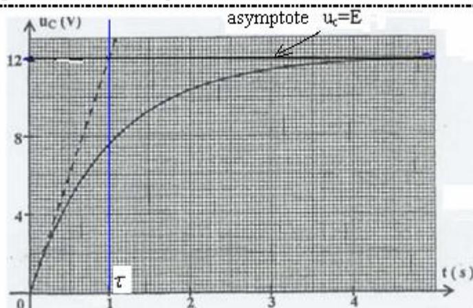
1-5- En régime permanent on a :  $u_C = E$  L'énergie électrique emmagasinée dans le condensateur  $\xi_e = \frac{1}{2} C u_C^2$
