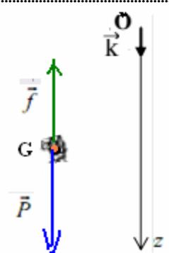
2) Lorsque la vitesse limite est atteinte on a :  $\frac{dv}{dt} = 0 \Rightarrow g \cdot \left( 1 - \frac{v_l^2}{\alpha^2} \right) = 0 \Rightarrow 1 - \frac{v_l^2}{\alpha^2} = 0$  d'où :  $\alpha = v_l$
