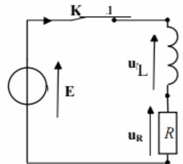
b) La solution :  $u_R = U_o(1 - e^{-\lambda t}) = U_o - U_o.e^{-\lambda t} \Rightarrow \frac{du_R}{dt} = \lambda U_o.e^{-\lambda t}$  en remplaçant dans l'équation différentielle :
