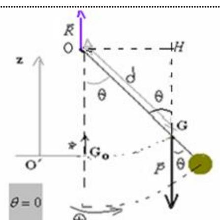
1.2- la solution de l'équation différentielle soit  $\theta = \theta_0 \cos\left(\frac{2\pi}{T_0} t\right)$
