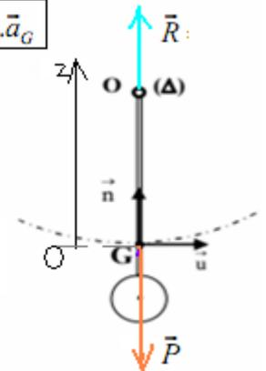
le pendule pesant de sa position d'équilibre stable d'un angle  $\theta_0 = \frac{\pi}{18}$  rad et on le libère sans vitesse initiale à l'instant  $t=0$  au moment de passage du pendule par sa position d'équilibre stable à l'instant :  $t = \frac{T_o}{4}$
