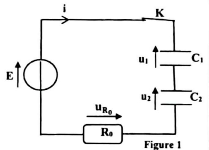
1-2- Montrer que l'équation différentielle vérifiée par  $u_2$  s'écrit :  $u_2 + \frac{R_0 \cdot C_1 \cdot C_2}{C_1 + C_2} \cdot \frac{du_2}{dt} = \frac{C_1 \cdot E}{C_1 + C_2}$  . (0,5pt)
