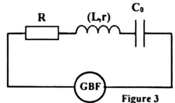
On visualise, à l'aide d'un système d'acquisition informatique adéquat, la tension  $u_R(t)$  aux bornes du conducteur ohmique et la tension  $u(t)$  aux bornes du générateur. On obtient l'oscillogramme représenté sur la figure 4.
