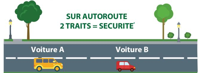
A un certain instant le conducteur de la voiture A aperçoit la lumière des freins de la voiture B, il décide alors de s'arrêter pour éviter la collision. le temps de réaction d'un conducteur fatigué est  $t_R = 2\text{s}$ . Les deux voitures ont la même distance de freinage  $d_f$ .
